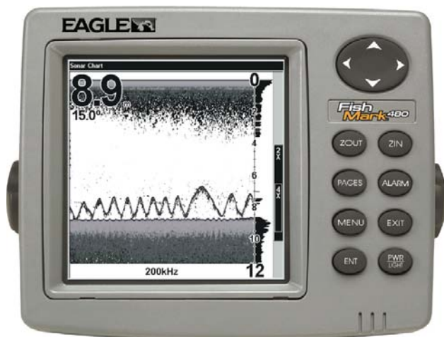
FishMark480 – na obrazovke je vytvorená krivka 3gramovým olovkom v 8m hĺbke
